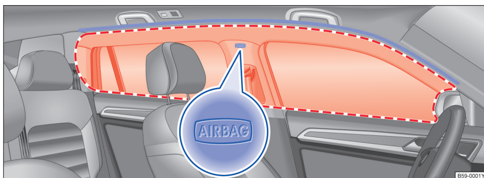
图 44 在汽车左侧：头部安全气囊的安装位置和膨胀范围
